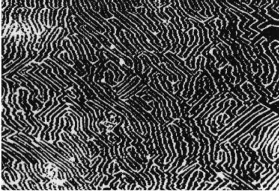
Şekil 9.1: Grainleri yönlendirilmemiş elektrik çeliğinin domain yapısı.
